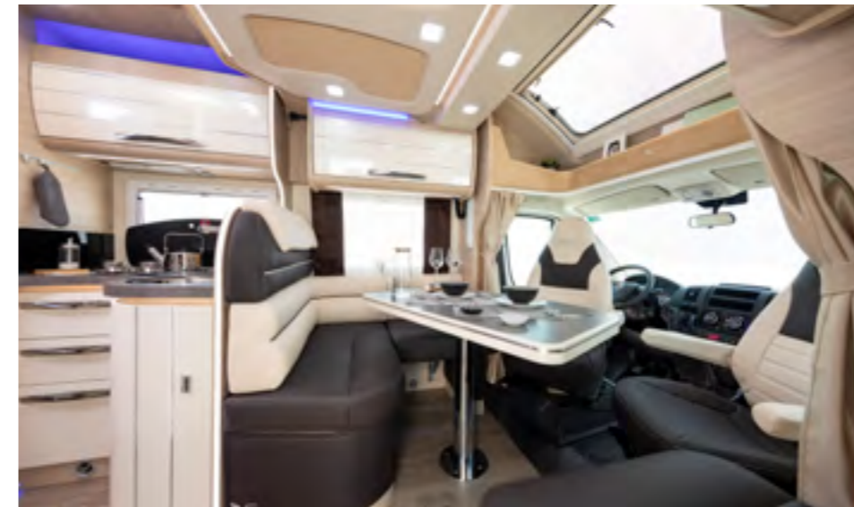
Die Fahrerhaussitze können um 180° gedreht werden, wobei die Bezüge auf die Polsterung abgestimmt sind. Sitze aus Polyurethanschaum mit doppelter Dichte.
