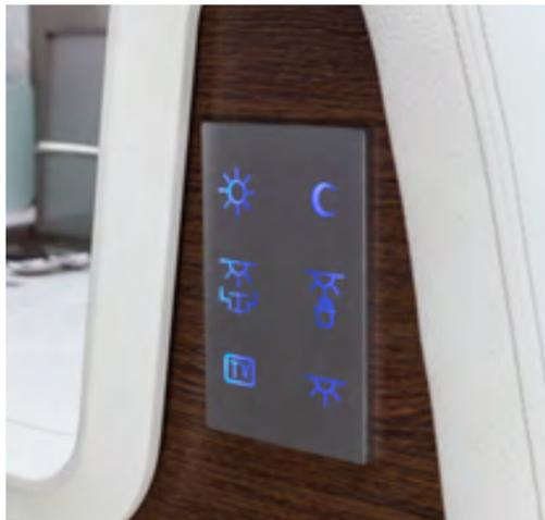
Intelligente Lin-Bus-Technologie, die die Anpassung der Beleuchtung der Räume mit Näherungsschaltern ermöglicht.
