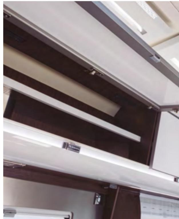
Oberschränke mit Holzrückenteilen für stabile und langlebige Möbel, die unterwegs keine Geräusche erzeugen. Das Aluminiumprofil im Inneren der Tür verleiht der gesamten Konstruktion eine höhere Stabilität. Abgerundete Befestigung am Aluminium-Wandelement.
