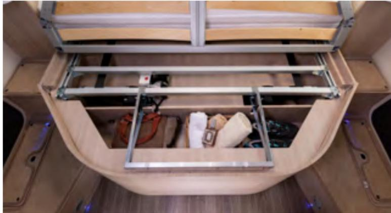
Hinteres Bett mit elektrischer Hubvorrichtung: Die Höhe so verstellen, dass der Platz dort zu Verfügung steht, wo er gebraucht wird: mehr Volumen in der Garage oder im Schlafzimmer (Modelle 79, 89, 90).
