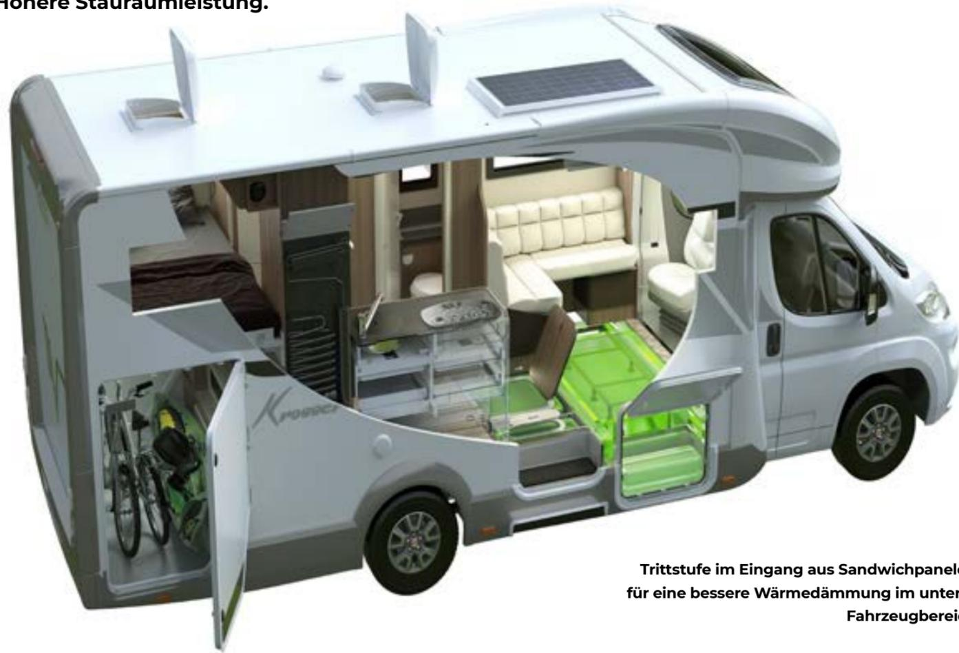
Trittstufe im Eingang aus Sandwichpanelen, für eine bessere Wärmedämmung im unteren Fahrzeugbereich.
