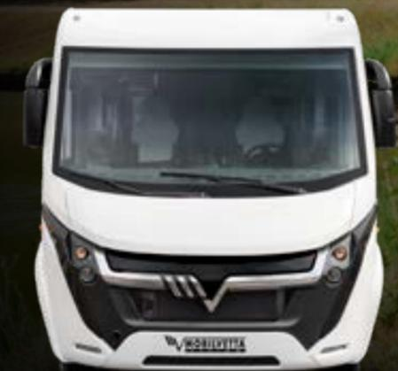
Die vorderen Säulen sind so platziert, dass sie dem Fahrer optimale Sicht und Kontrolle gewährleisten. Die breit und bündig eingelassenen Seitenfenster, erzeugen auch bei höheren Geschwindigkeiten während der Fahrt keine Turbulenzen oder Geräusche.
