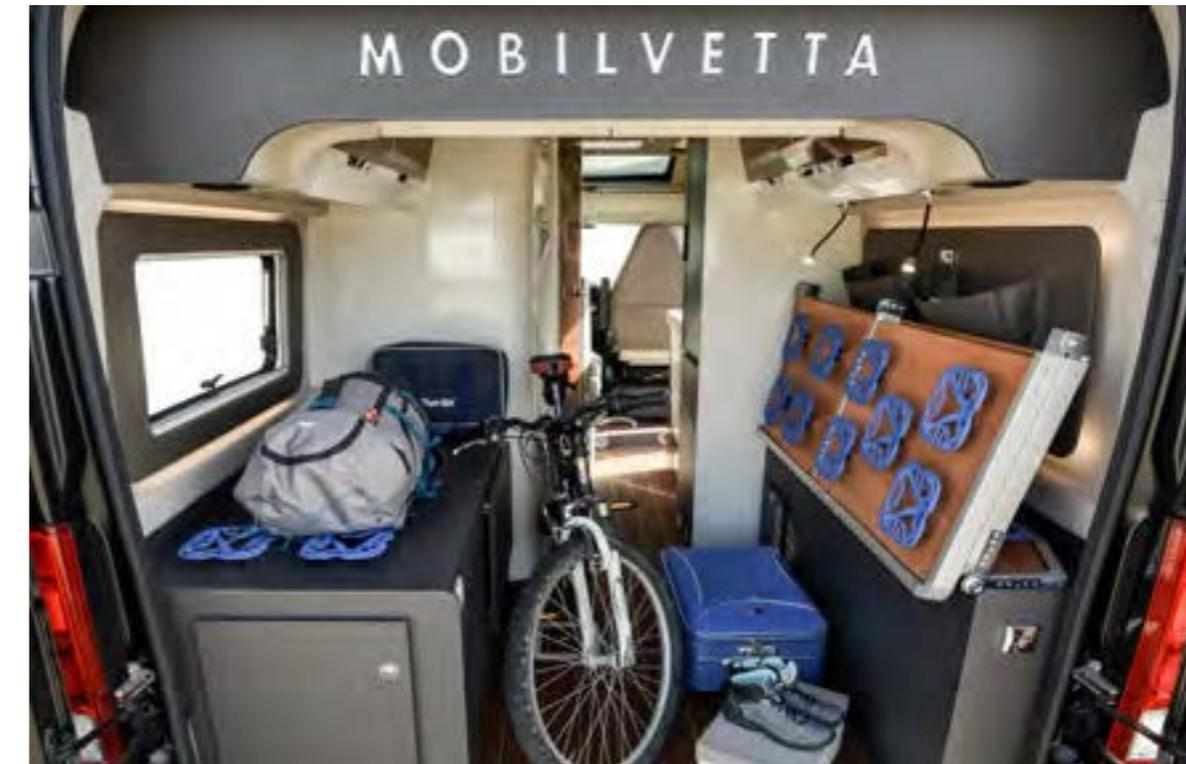
Das Doppelquerbett hinten, mit anhebbaren Lattenroste, die somit die Unterbringung von sperrigen Ladegütern wie Fahrrädern oder Rollern gewährleisten. Der Boden ist eben und stufenlos.
