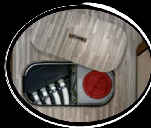
**3 VOR VEREISUNG GESCHÜTZTE TANKS.** Die Tanks befinden sich zwischen den beiden Böden: in dieser Position sind sie vor Vereisung geschützt und von der Außenumgebung besser isoliert. Zugang zu Ablaßhähnen und Frischwassertank über entsprechende Zugangsluken.
